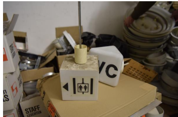
Abb. 2.1.158 Ausgebaute Hinweisleuchten, Foto: strebewerk. 2018
