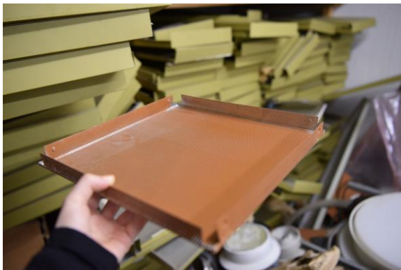
Abb. 2.1.05 Materiallager, rotes quadratisches Deckenpaneel aus gefalztem Stahlblech, Foto: strebewerk. 2018
