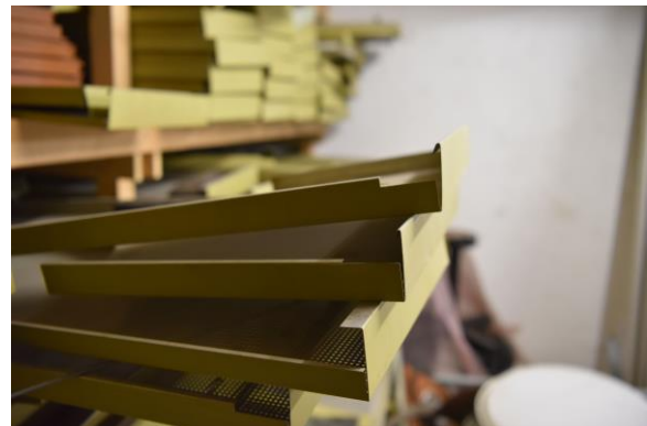
Abb. 2.1.06 Materiallager, grüne gedrungene rechteckige Deckenpaneele aus gefalztem Stahlblech, Foto: strebewerk. 2018
