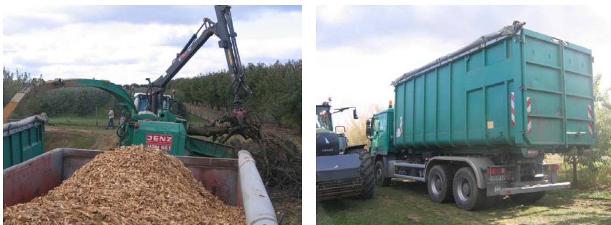
Abbildung 3: Erfassung und Abtransport des Hackgutes in Wechselcontainern
