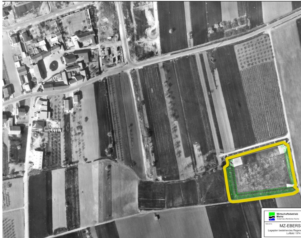
Anfang der 1970er Jahre wurde das bestehende Ebersheimer Regenrückhaltebecken „An der Wiese“ gebaut. Seine Aufgabe: Bei stärkeren Niederschlägen das Schmutz- und Regenwasser (**Mischwasser**) zwischenspeichern und erst nach Ende des Regens wieder abzugeben, um so die Kanalisation zu entlasten. Das Grundstück, auf dem das Becken entstand, lag damals deutlich außerhalb der Ebersheimer Ortsgrenzen.
