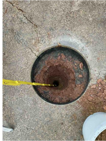
Abbildung 14: Bohrkern- und Bodenmaterialentnahme für Untersuchung zur Schadensfeststellung
