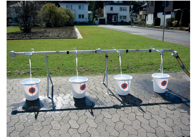
Wasserverteilung über eine Zapfstelle.
