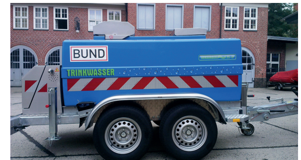
Wassertransportanhänger als mobile Komponente. (Quelle: Feuerwehr Görlitz; übrige: BBK)
